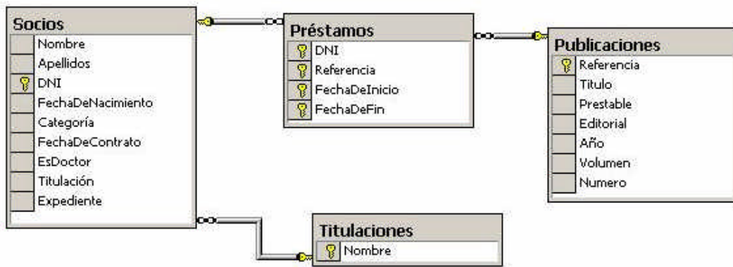
Figura 56. Diagrama resultante de aplicar el patrón una árbol de herencia, una tabla al diagrama de clases de la Figura 52
