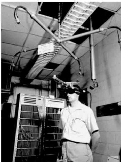
Figura 4.10: Brazo mecánico usado para medir la orientación de la cabeza del usuario
