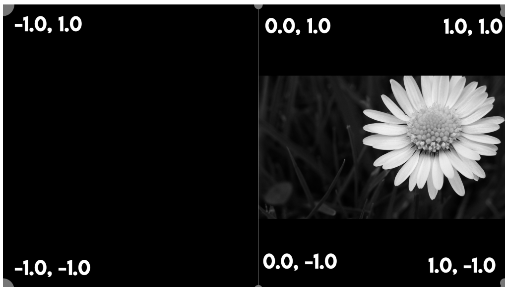
Figura B.3: Ejemplo de combinación de las funciones de reajuste y posición.
