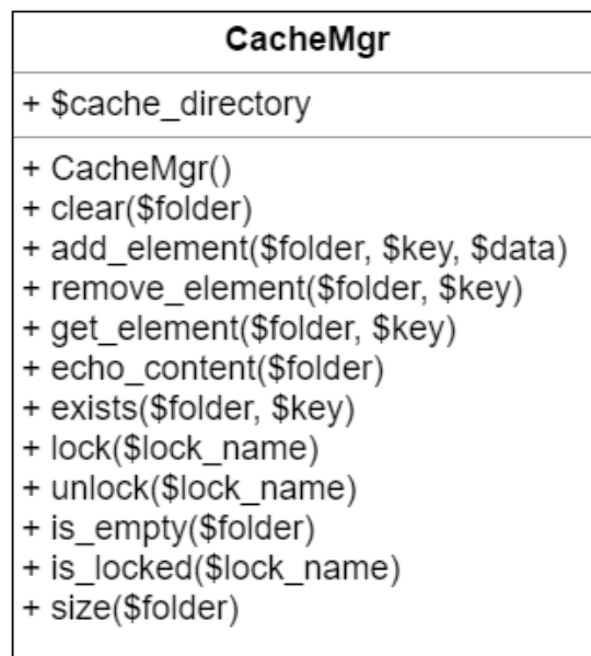
Figura 5.25: Diagrama UML de la clase CacheMgr .
