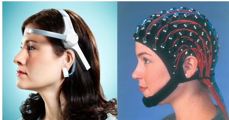
Figura 1.2: Dispositivos de EEG para interfaces naturales.
