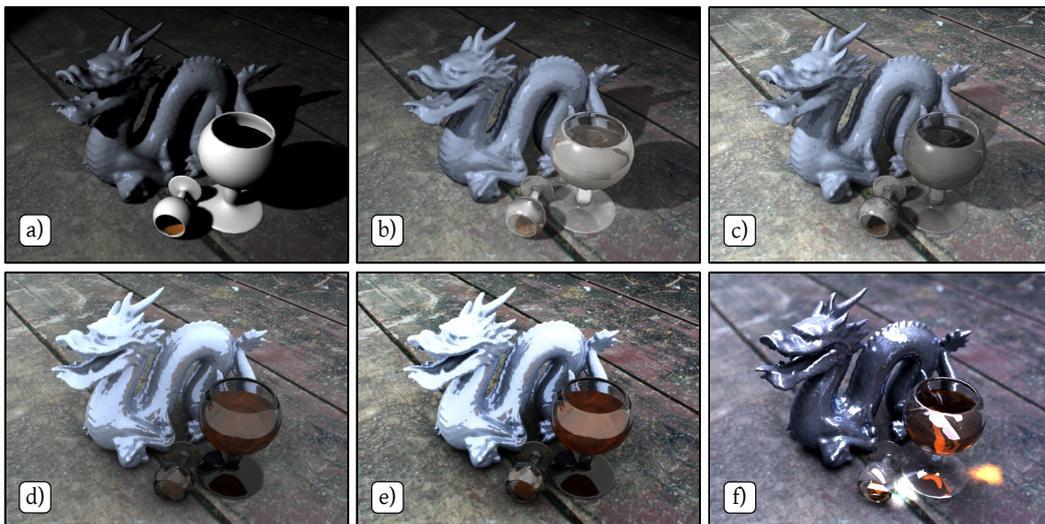
Figura 3.16: Resultados de la misma escena con diferentes métodos de render: a) RayCasting b) RayTracing (Whitted) c) Ambient Occlusion d) PathTracing (Skydome) e) PathTracing (Un foco de iluminación directa) f) PathTracing + Photon Mapping (+ Iluminación basada en imagen HDR) (ver versión a color en C.1).
